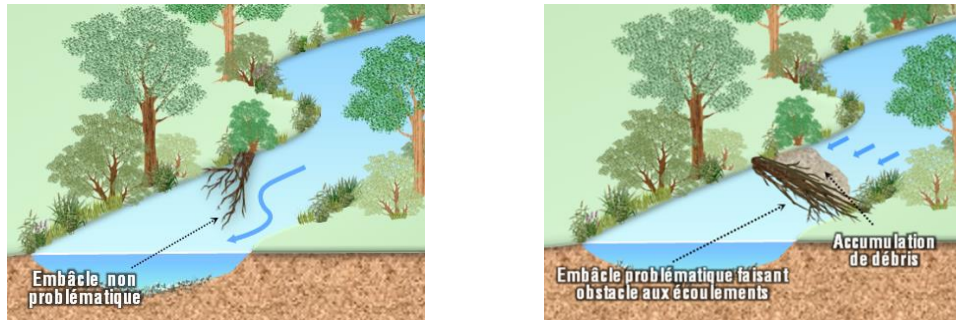
Schéma de principe des travaux de retrait d'embâcles
