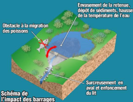
Schéma de l'impact des barrages
