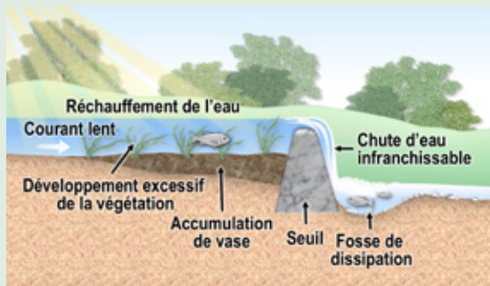
Seuil faisant obstacle à la continuité écologique
